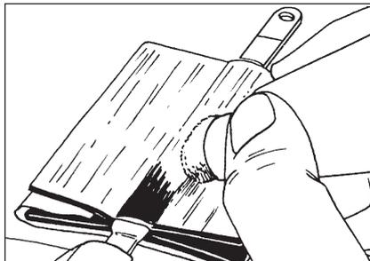
2 Retire el papel de protección y lubrique abundantemente la superficie ancha entre las solapas del clip.
